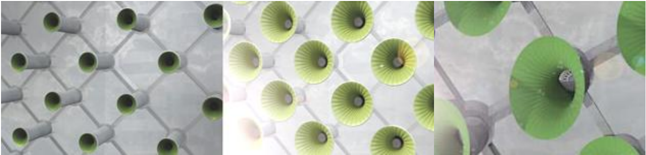
La struttura della pelle. Simulazione durante le ore serali (pori chiusi). Simulazione durante le ore maggiormente illuminate (pori aperti). Micro captatore energetico capace di accumulare l'energia generata dal vento e dal rumore.
